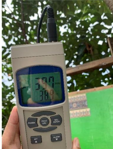
Gambar 4. 2 Alat CO2 Meter Pada Saat Pengambilan Sampling (lokasi titik 7)
