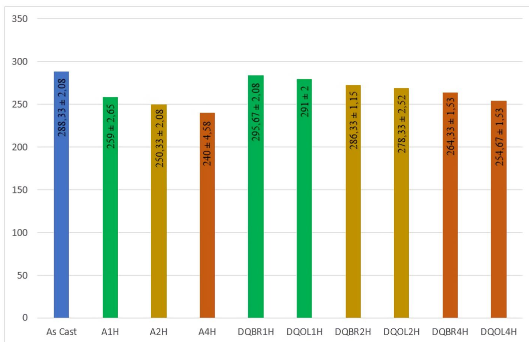
Gambar 4.7 Grafik hasil pengujian kekerasan Cu-16,8Zn-6,99Al
