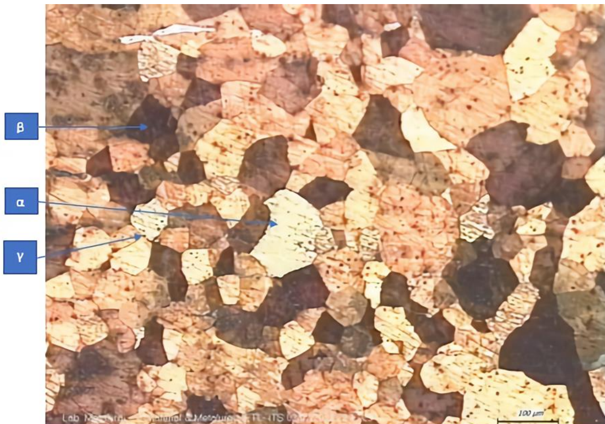
Gambar 4.3 Hasil metalografi spesimen as cast Cu-16,8Zn-6,99Al dengan perbesaran 100x dan menggunakan larutan etsa \text{FeCl}_3 \cdot 6\text{H}_2\text{O}
