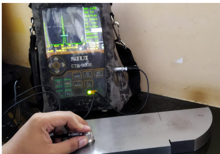
Gambar 4. 8 Skema Pengujian Ultrasonik
