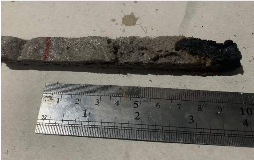
Gambar Hasil Spesimen Setelah dilakukan Pengujian Flame Retardant
