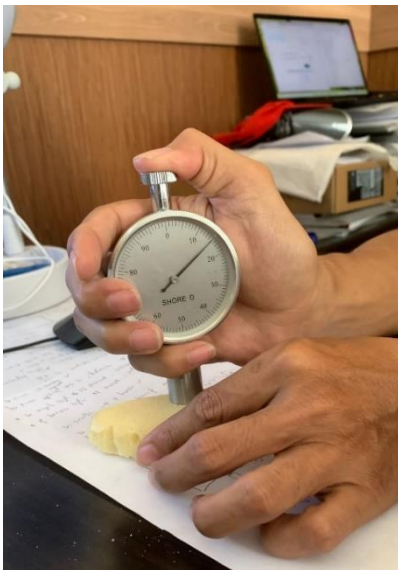
Gambar Hasil Uji Hardness Poluretan Murni
