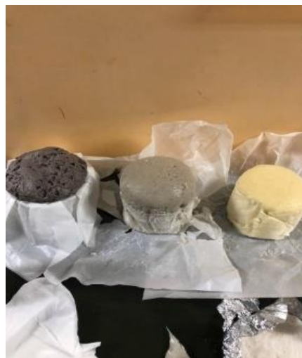
Gambar 3. 3 Hasil Pembuatan Komposit Poliuretan/Nanoselulosa/Barium Heksaferit
