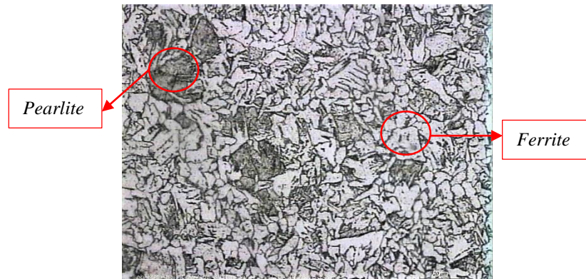
Gambar 4.5 Metalografi heat affected zone spesimen JR 220 dengan perbesaran 500x
