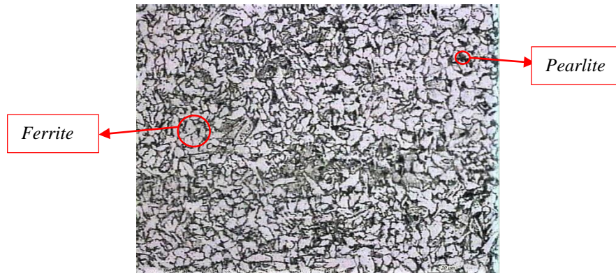
Gambar 4.17 Metalografi heat affected zone spesimen J2 240 dengan perbesaran 500x
