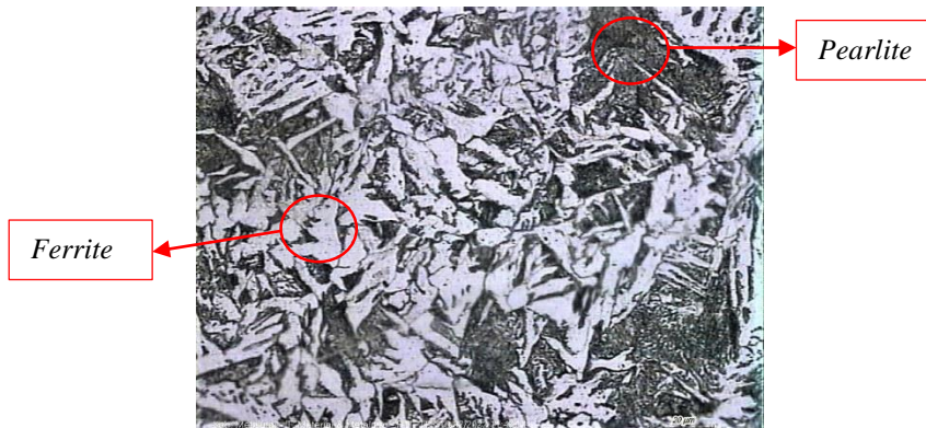
Gambar 4.11 Metalografi heat affected zone spesimen J2 200 dengan perbesaran 500x
