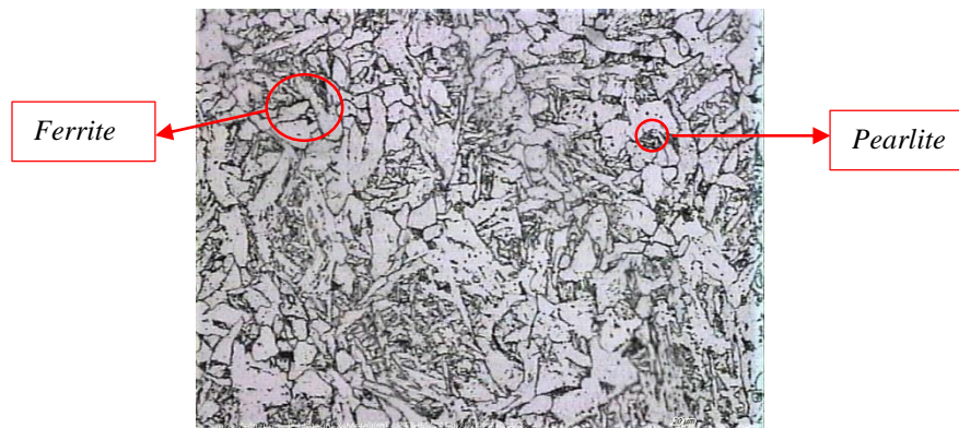
Gambar 4.6 Metalografi weld metal spesimen JR 220 dengan perbesaran 500x
