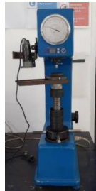
Gambar 3.4 Alat uji kekerasan (Dokumentasi Pribadi, 2022)
