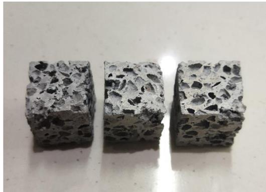
**Gambar 4.2** Spesimen uji densitas dan porositas
