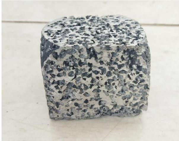
**Gambar 2** Spesimen aluminium *foam* yang berhasil (dokumentasi pribadi)
