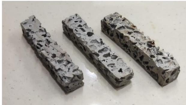
**Gambar 4.16** Spesimen uji impak
