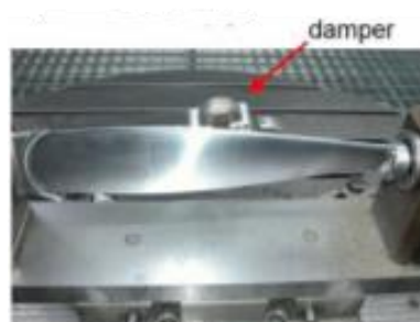
Gambar 2.14 Hasil Permukaan Benda Kerja dengan DVA (S. Bolsunovsky, 2013)
