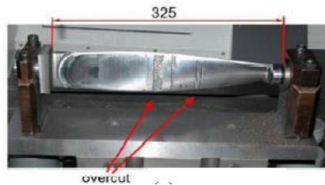
Gambar 2.13 Hasil Permukaan Benda Kerja tanpa DVA (S. Bolsunovsky, 2013)
