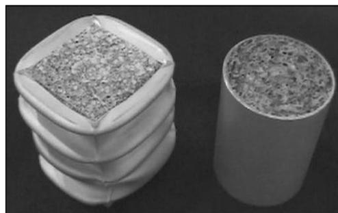
**Gambar 2.3** Gambar Prototipe tabung berisi *foam* dikembangkan sebagai peredam benturan(Kusyairi et al., 2018)
