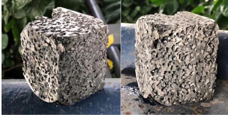
Spesimen aluminium *foam* hasil pengecoran (berhasil)
