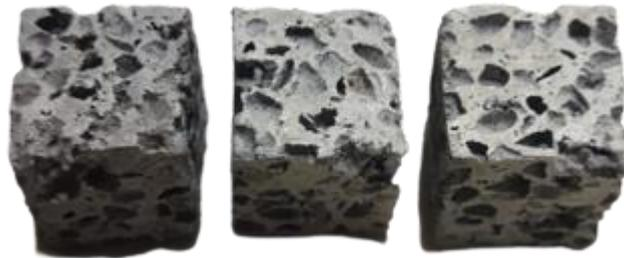
**Gambar 4.8** Spesimen uji kompresi paduan Al-Mg-Si foam
