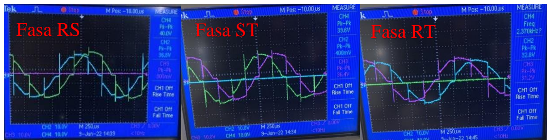
Gambar 4. 15 Pengujian bentuk gelombang tegangan output dengan beban 2 fasa
