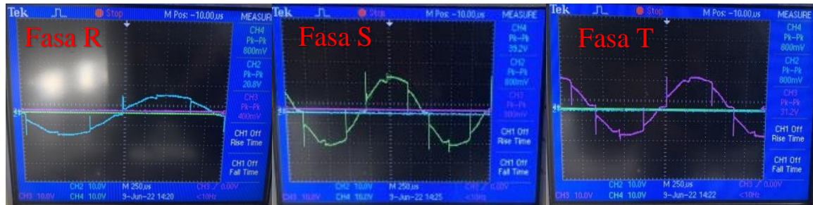
Gambar 4. 14 Pengujian bentuk gelombang tegangan output dengan beban 1 fasa
