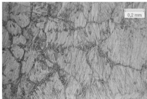
Gambar 2. 17 Struktur mikro paduan A up-quenching dengan aging pada 400°C selama 50 menit (Asanovic, 2021)
