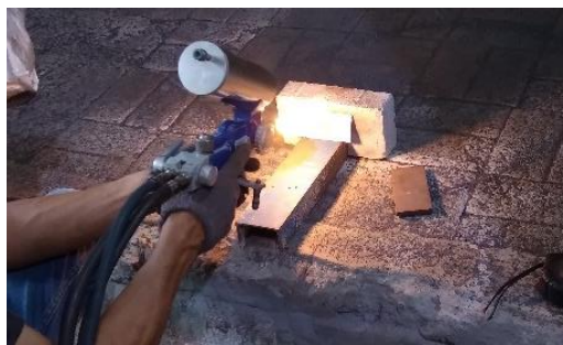
Gambar 3.24 Proses thermal spray
