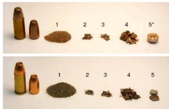
Gambar 2.3 Proyektil frangible dan pecahannya
