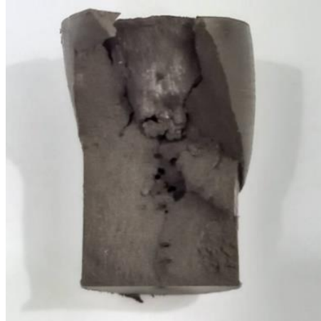
Gambar 4.10 Pola patahan pada speismen uji tekan PA6/85FeNi
