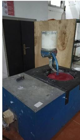
**Gambar 3.6** Mesin *Grinding* dan *Polishing* (Dokumentasi pribadi, 2022)
