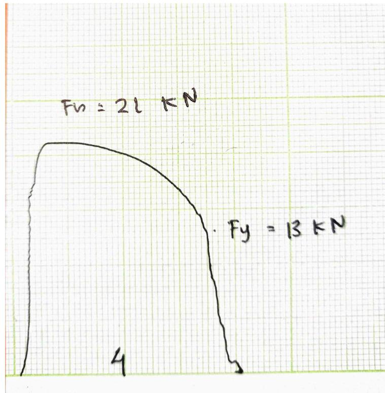
Contoh Perhitungan Yield Strength, Ultimate Tensile Strength dan Persentase Elongasi pada spesimen Stainless Steel 316 dengan waktu sensitisasi 5 jam
