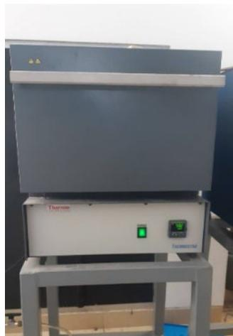
**Gambar 3.2** *Muffle Furnace* (Dokumentasi Pribadi, 2022)
