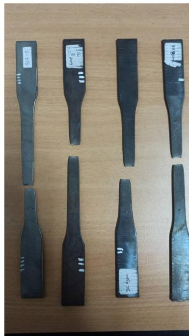
Hasil Pengujian Tarik Spesimen SSWT
