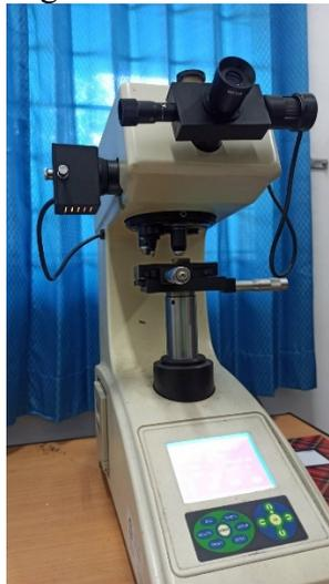
**Gambar 3.4** Alat Uji Kekerasan *Micro-Vickers* (Dokumentasi pribadi, 2022)
