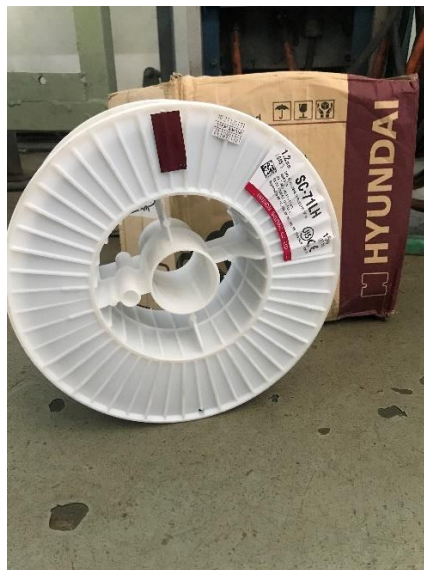
Gambar 3.5 Filler FCAW SC-71LH (E71T-1C) (Dokumentasi Pribadi, 2022)
