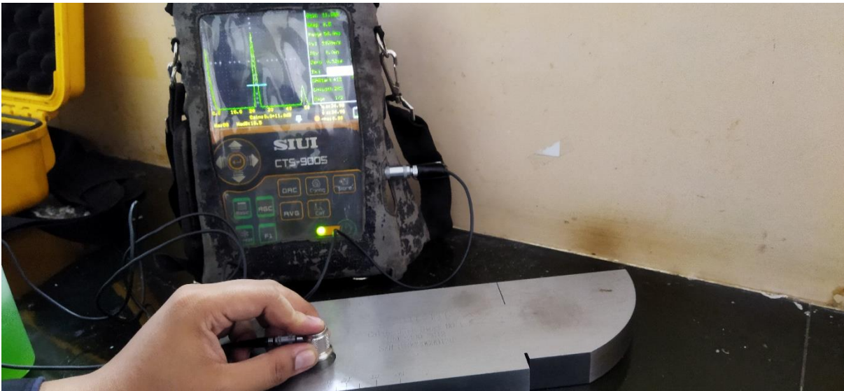
Gambar 4.7 Set Up Pengujian Sensitivitas Gelombang Ultrasonik Material Kuplan H 2 O/MC/AV
