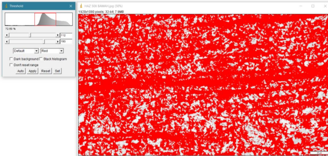
F37. Hasil Persentase Fasa Ferrite Pada Base Metal Spesimen AA-19
