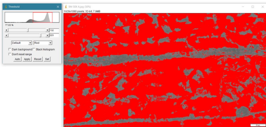
F12. Hasil Persentase Fasa Ferrite Pada Base Metal Spesimen ID-19
