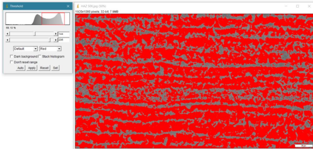
F11. Hasil Persentase Fasa Pearlite Pada HAZ Spesimen ID-19
