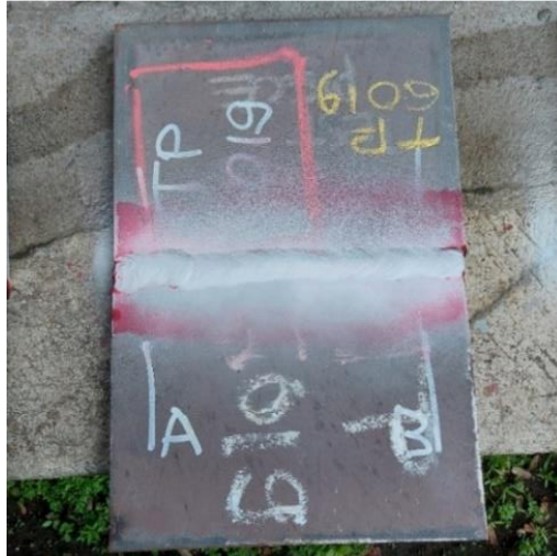
Gambar 4. 5 Hasil Pengujian Penetrasi Pada Test Piece ID-19
