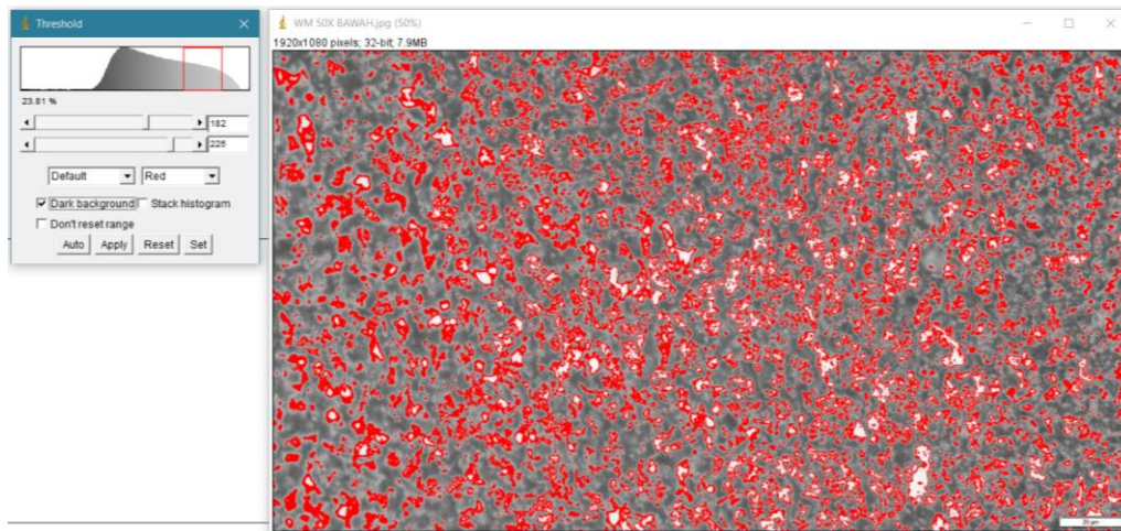
F32. Hasil Persentase Fasa Pearlite Pada Weld Metal Spesimen AA-19 Bagian Root
