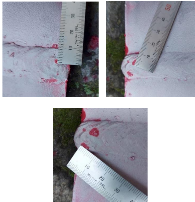
Gambar 4. 2 Rounded Indications dengan ukuran 3 x 3 mm (kiri), 5 x 5 mm (kanan), dan 5x3 mm (bawah) Pada Test Piece AA-19
