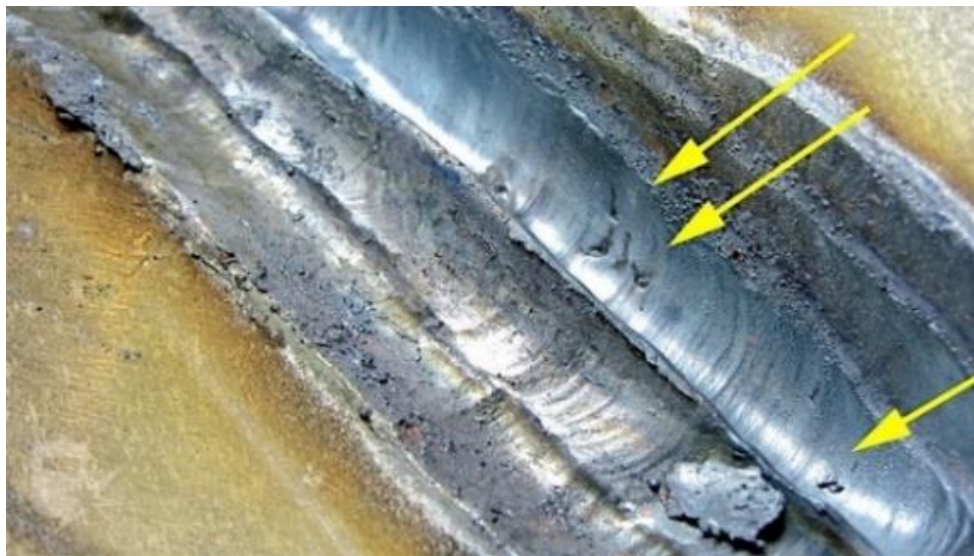
Gambar 2. 13 Slag Inclusion Pada Pengelasan (Warman, 2017)
