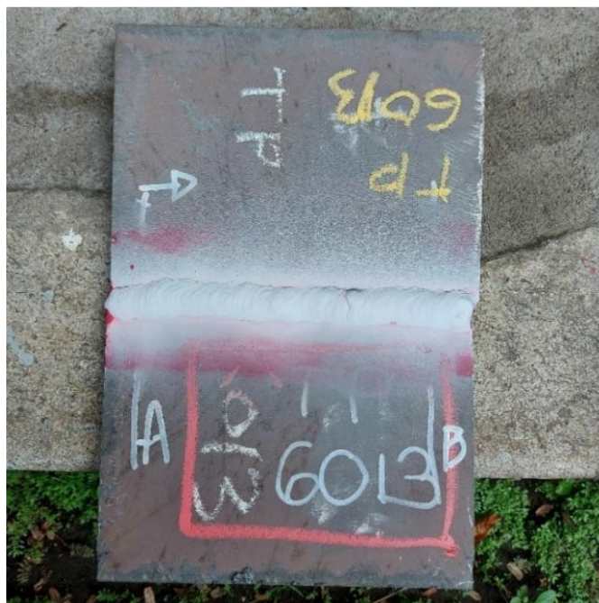
Gambar 4. 4 Hasil Pengujian Penetran Pada Test Piece ID-13
