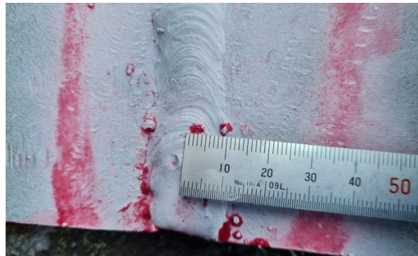
Gambar 4. 1 Rounded Indication Pada Test Piece AA-13
