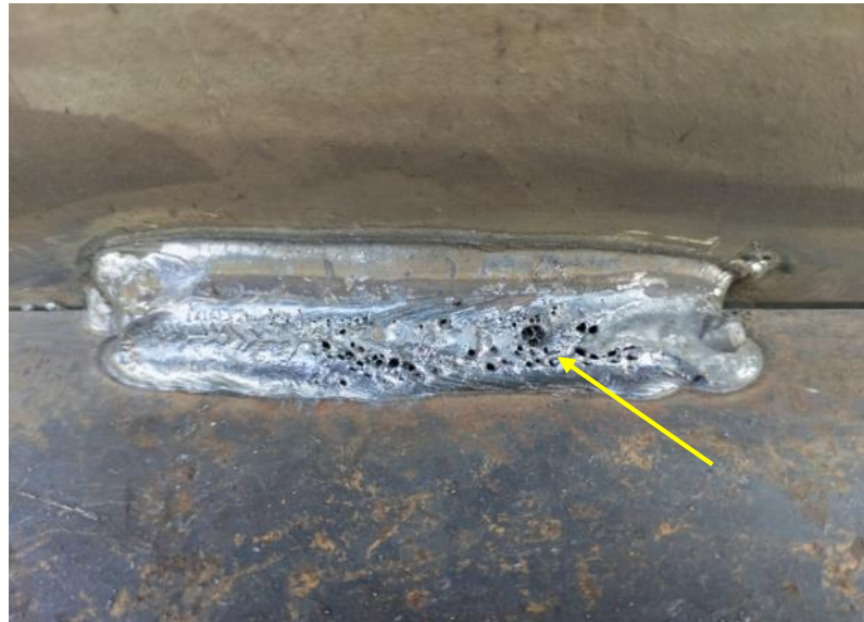
Gambar 2. 12 Porositas Pada Pengelasan (Sahlan, 2015)
