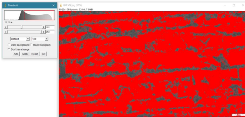
F38. Hasil Persentase Fasa Pearlite Pada Base Metal Spesimen AA-19
