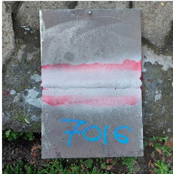
Gambar 4. 3 Rounded Indications dengan ukuran 11 x 12 mm Pada Test Piece AA-16
