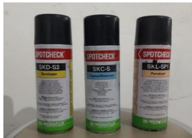
Gambar 3. 4 Tiga Jenis Spray untuk Pengujian Penetran
