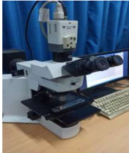
Gambar 3.3 Mikroskop Optik OLYMPUS BX-51M (Dokumentasi Pribadi, 2022)
