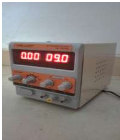
Gambar 3.5 Rectifier (Dokumentasi Pribadi, 2022)
