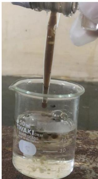
**Gambar 4.3** Pembuatan *beads* dengan metode *dropping*
