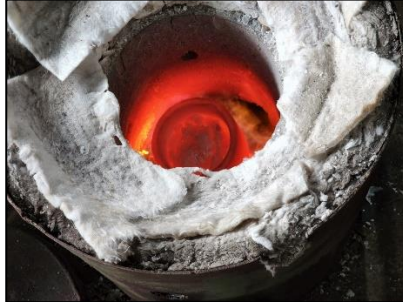
Proses pengecoran aluminium foam dalam burner .
