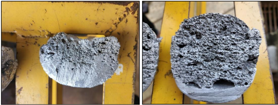
Hasil pengecoran yang gagal (kiri), dan pengecoran yang berhasil (kanan).
