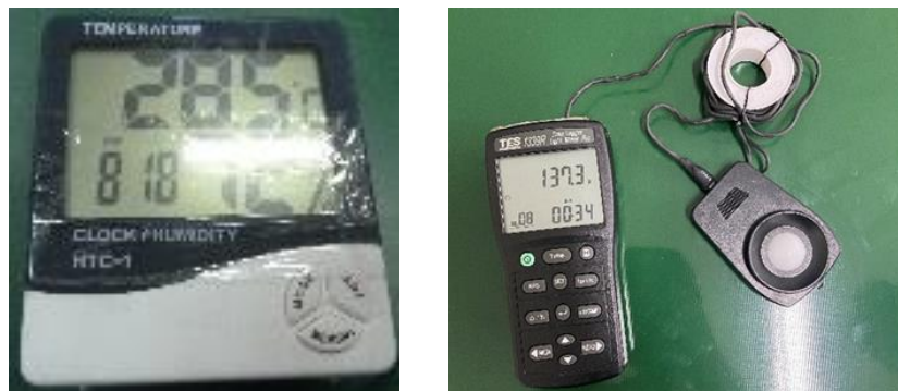
Gambar 4.1 (a) Hasil pengukuran suhu dan kelembaban ruangan (b) Hasil pengukuran intensitas cahaya
