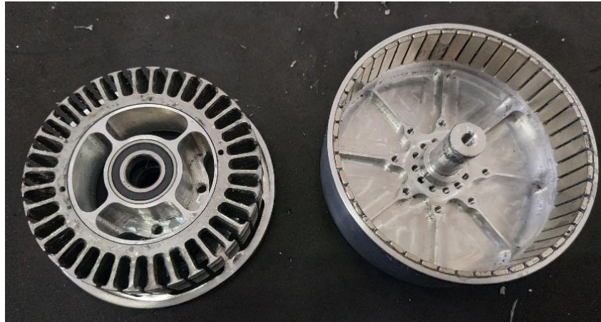
Gambar 3. 19 (a). rotor dan stator tampak atas (b). rotor dan stator tampak bawah (c). pemasangan inti stator dan magnet permanen
