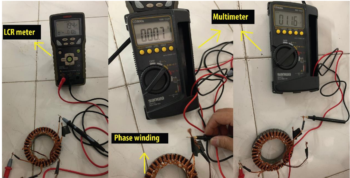
Gambar 3. 24 Pengukuran induktansi, resistansi, dan kapasitansi fasa
