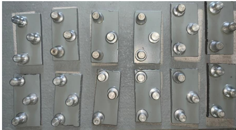
Gambar 4.13 Spesimen yang telah dipasang Dolly
