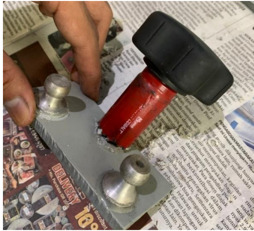
Gambar 3.22 Proses Pembersihan Pinggiran Lem pada Dolly dengan Dolly Cutter
