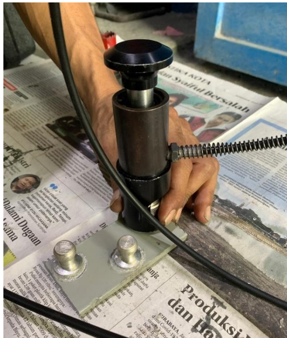
Gambar 3.23 Proses Penarikan Dolly dengan Portable Adhesion Tester
