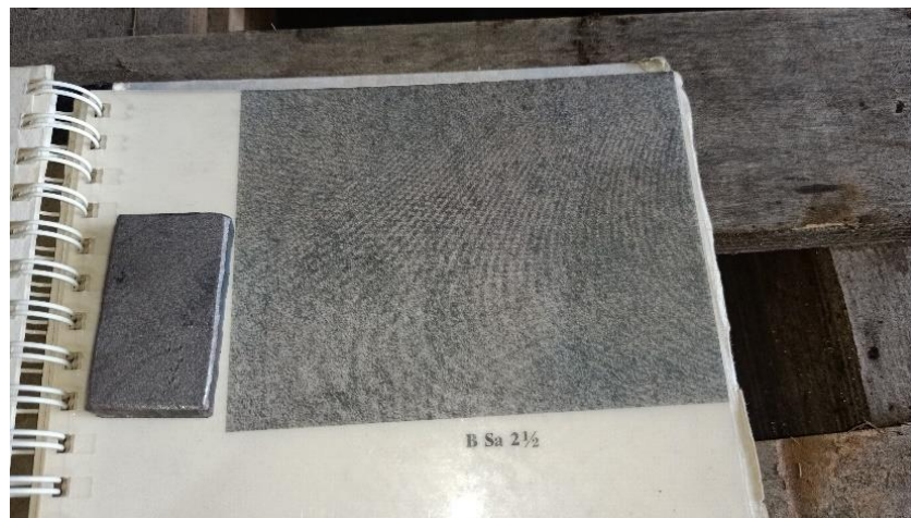
Gambar 3.12 Inspeksi Visual Blasting dengan ISO 8501-1
