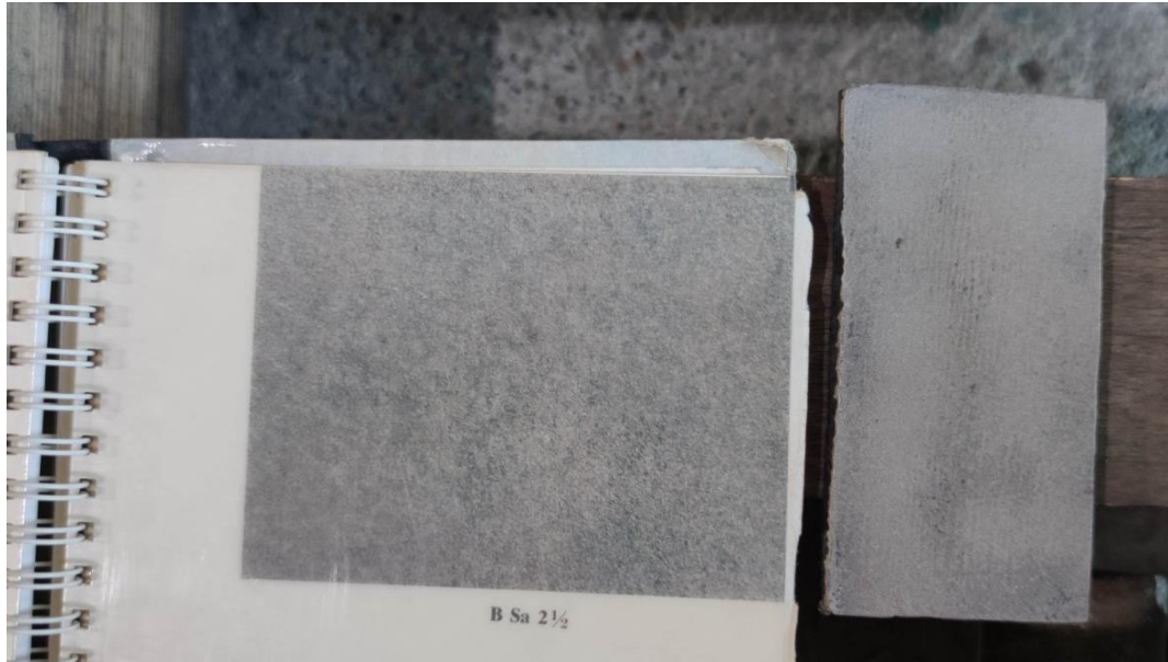
Gambar 4.5 (kiri) Panduan kebersihan Sa 2½ (ISO 8501-1) dan (kanan) spesimen yang telah dilakukan blasting
