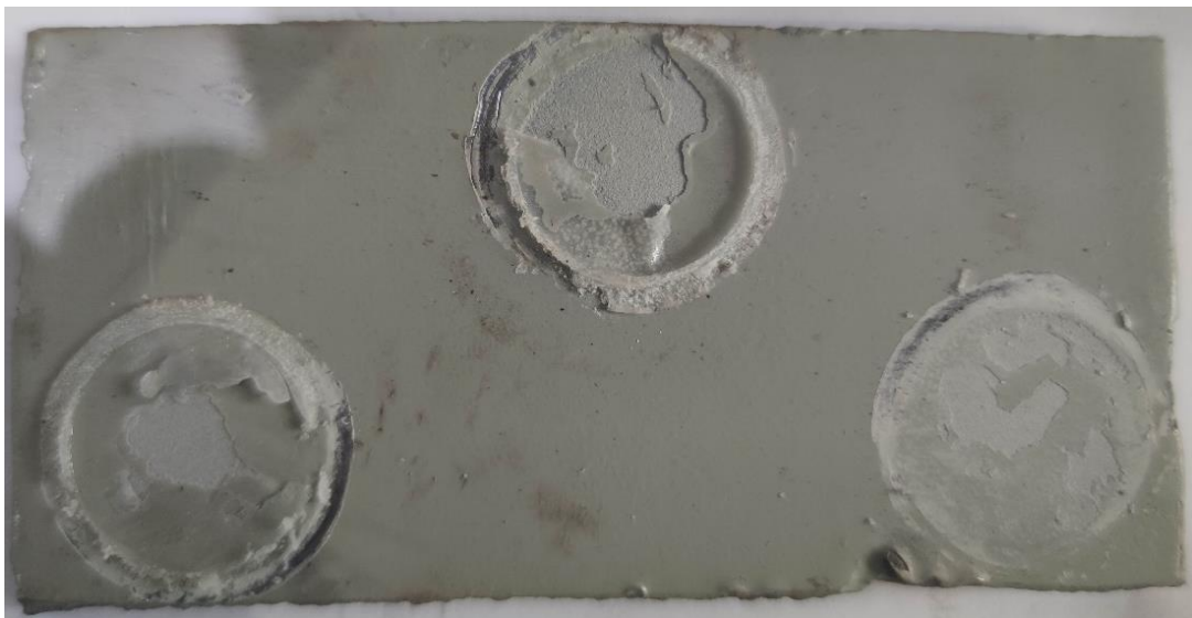
Gambar C.2 Hasil Pengujian Adhesi Spesimen AB2
