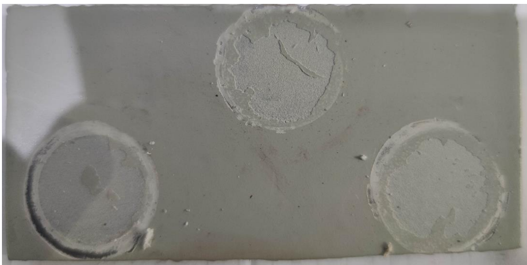
Gambar C.3 Hasil Pengujian Adhesi Spesimen AB3
