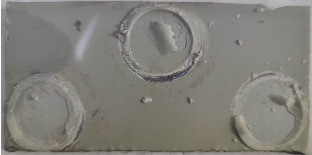
Gambar C.1 Hasil Pengujian Adhesi Spesimen AB1
