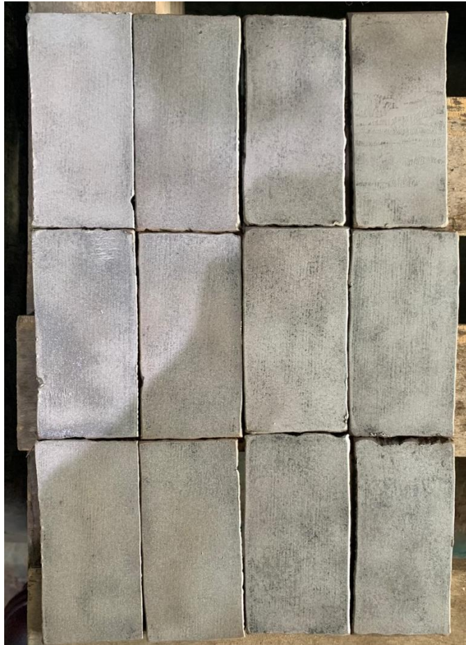
Gambar 4.4 Spesimen Baja A36 setelah Blasting
