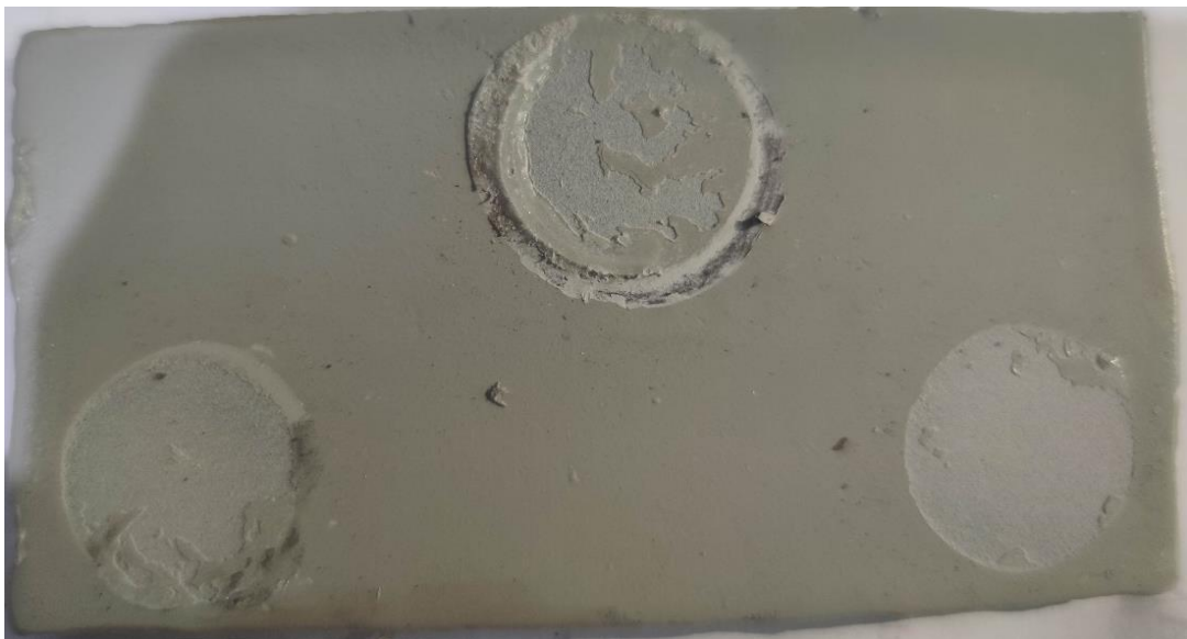
Gambar C.11 Hasil Pengujian Adhesi Spesimen AT2
