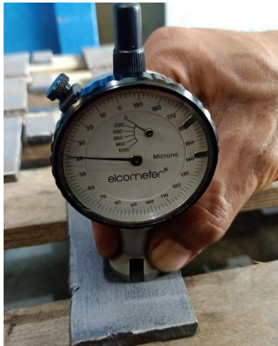
Gambar 3.13 Pengukuran Kekasaran Permukaan dengan Roughnessmeter
