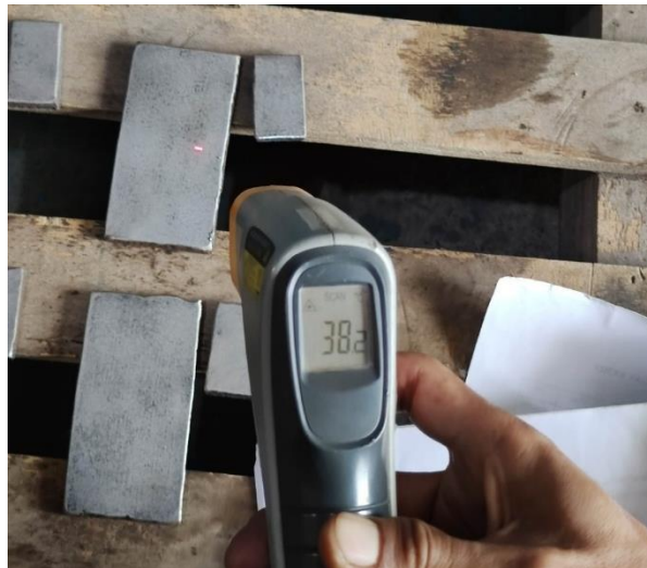
Gambar 4.2 Pengukuran Temperatur Spesimen
