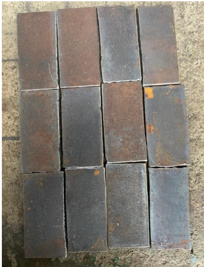
Gambar 4.3 Spesimen Baja A36 sebelum Blasting
