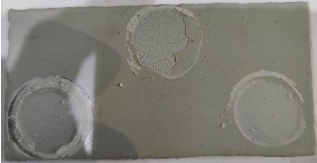
Gambar C.4 Hasil Pengujian Adhesi Spesimen AS1
