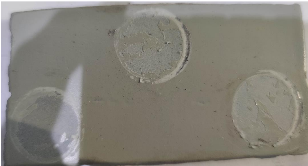
Gambar C.9 Hasil Pengujian Adhesi Spesimen AD3
