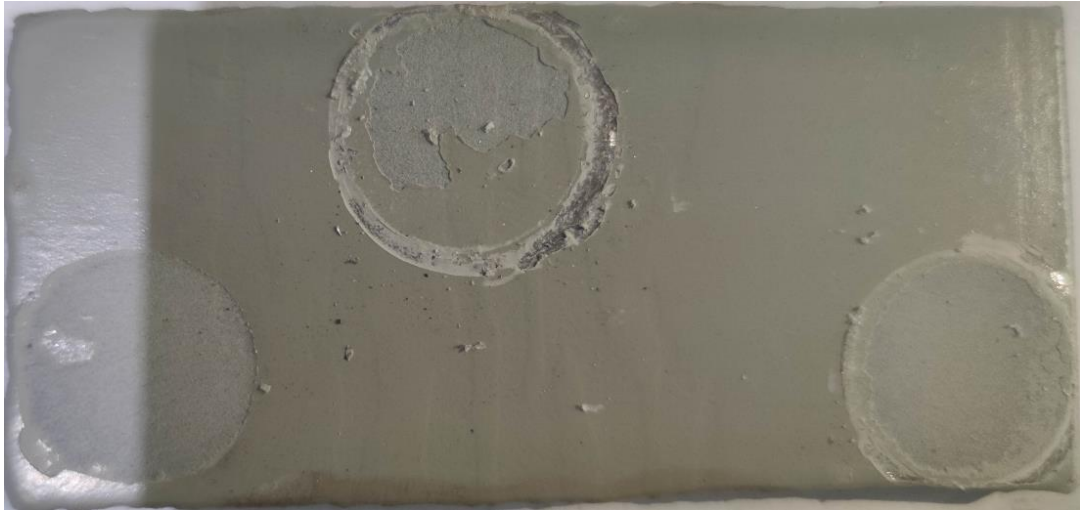
Gambar C.10 Hasil Pengujian Adhesi Spesimen AT1
