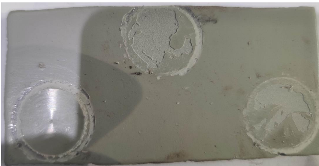
Gambar C.6 Hasil Pengujian Adhesi Spesimen AS3
