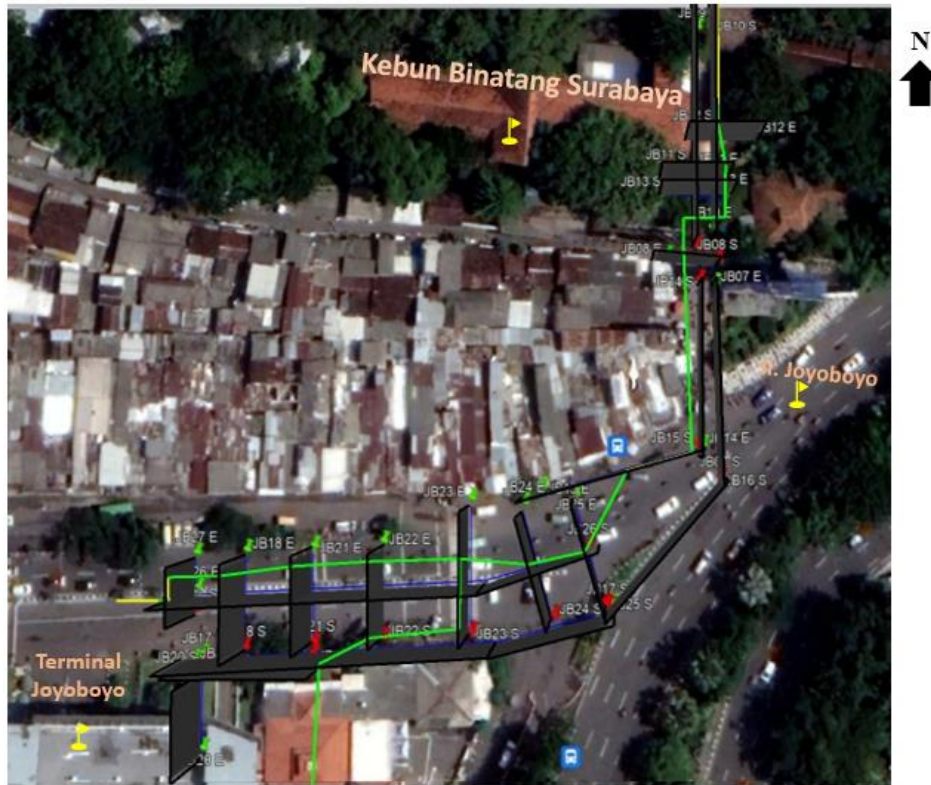
Gambar 4.19 Pemodelan 2,5-D Lintasan JB07 s/d JB27 Beserta Kemungkinan Struktur Jaringan Pipa Air Bawah Permukaan (Garis Hijau dan Garis Kuning).
