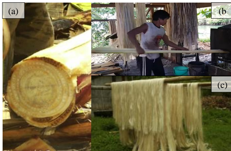
Gambar 2.2 Proses pembuatan serat abaka (a) Batang pisang (b) Mesin decorticator (c) Serat abaka dijemur di bawah sinar matahari
