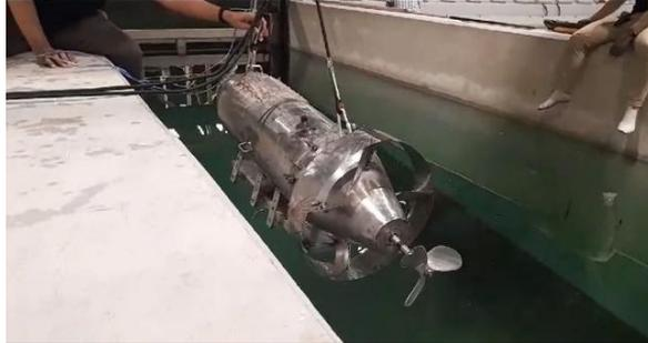
Gambar 3. 23 Pengujian Kestabilan Body AUV
