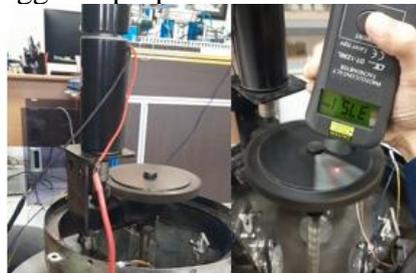
Gambar 3. 19 Pengujian Motor DC untuk Propeller
