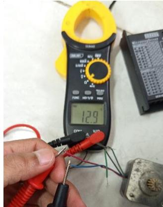
Gambar 2. 12 Tampilan Avometer ketika Kabel Stepper Motor Sepasang
