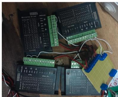
Gambar 3. 16 Rangkaian Integrasi Empat Driver Stepper
