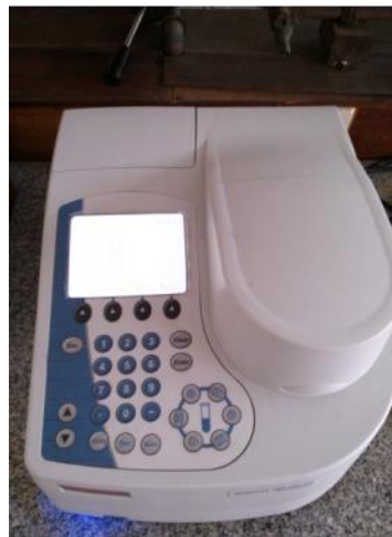
Gambar 3. 10 Mesin UV-Vis Genesys 10S UV-Vis Spectrometer (Dokumen Pribadi)
