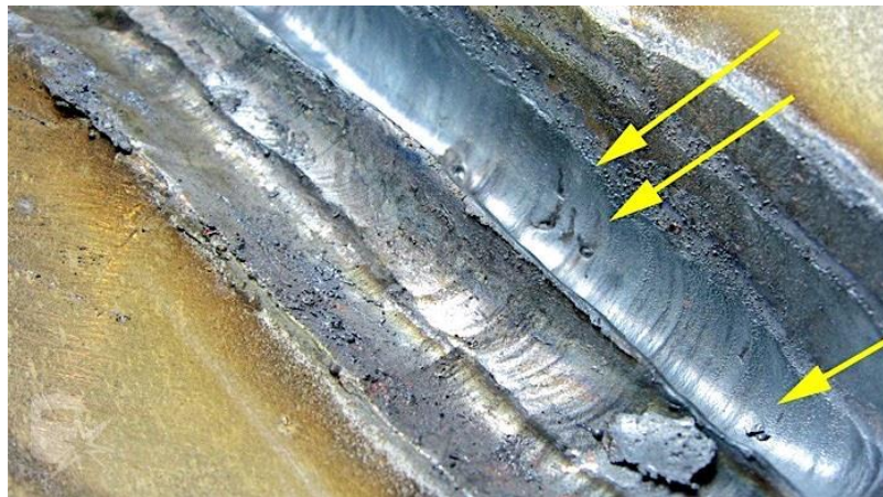
Gambar 2. 12 Cacat Slag Inclusion (Dodo et al., 2016)
