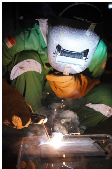
Gambar 3. 4 Proses Pengelasan Test Piece Di Atas Permukaan Air
