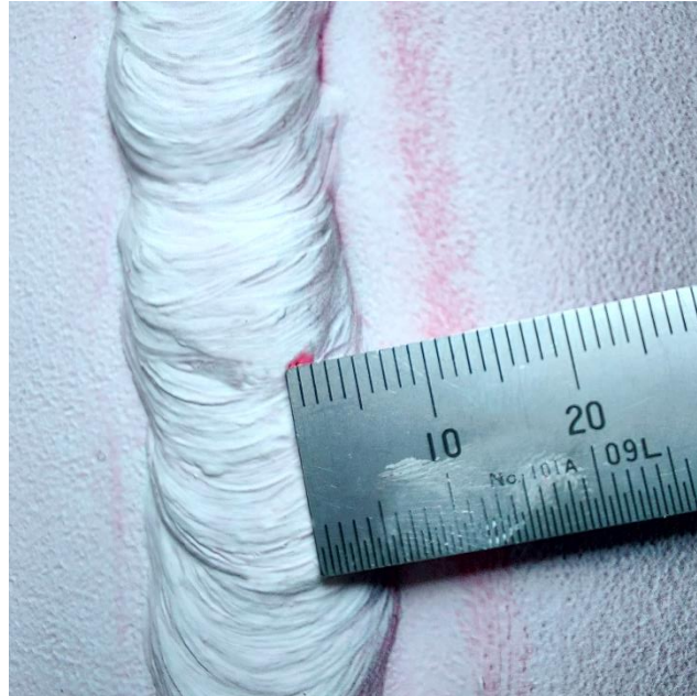
Gambar 4. 2 Rounded Indication pada Spesimen Preheat 100°C (W-P100)
