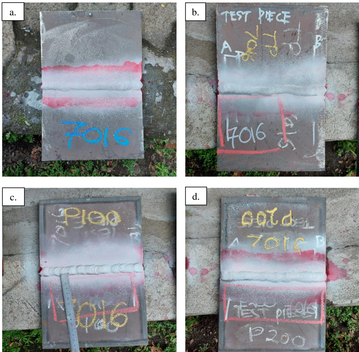
Gambar 4. 1 Hasil Penetrant Test (PT) pada Spesimen (a.) D-NP, (b.) W-NP, (c.) W-P100 dan (d.) W-P200
