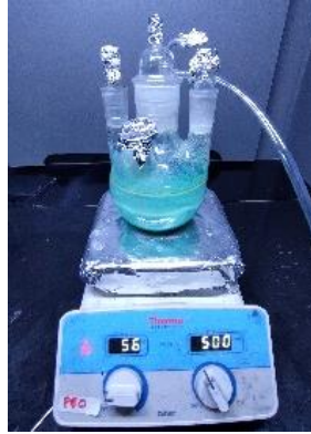
Gambar 3.3 Proses Pencampuran Prekursor.
