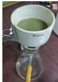
Gambar 3.4 Proses Pencucian dan Penyaringan.
