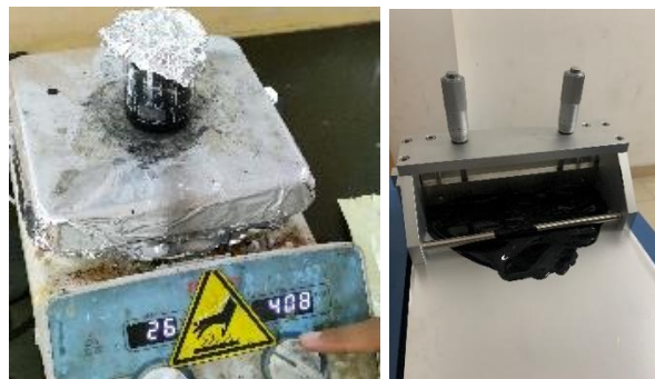
Gambar 3.10 (a) Proses Pengadukan Slurry ; (b) Pelapisan pada Foil Aluminium.
