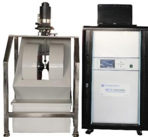
Gambar 3. 9 Alat Uji VSM
