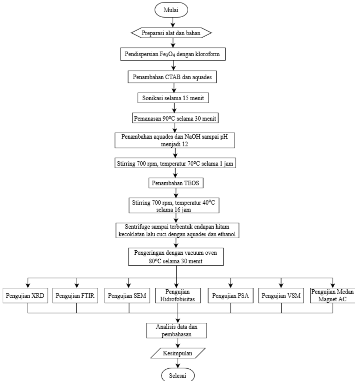
Gambar 3. 2 Diagram alir sintesis Fe 3 O 4 /SiO 2
