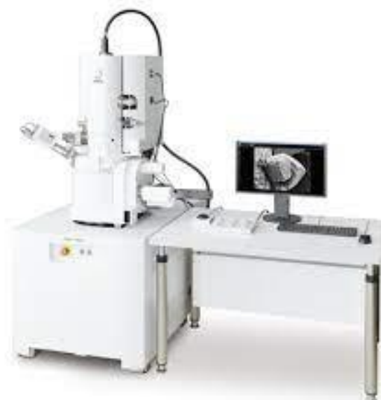
Gambar 3. 6 Alat Uji SEM
