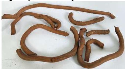
Gambar 4. 5. *Filament* komposit Cu/PA6
