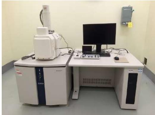
Gambar 3. 12. Mesin Uji SEM HITACHI SU3500
