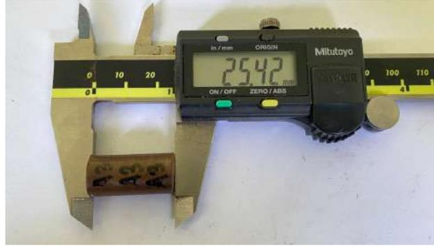
Gambar 3. 10. Spesimen Uji Tekan
