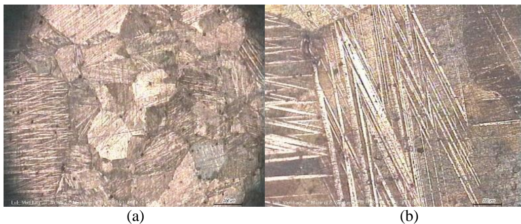
Gambar 2.12 Struktur mikro up-quenching holding time 10 menit dengan media pendingin (a)air, (b) oli(Herdiansyah, 2022).
