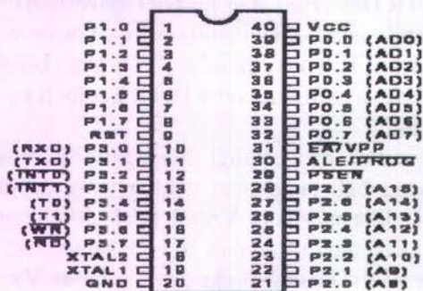
Gambar 2.19 Konfigurasi Pin IC AT89S51 [11]
