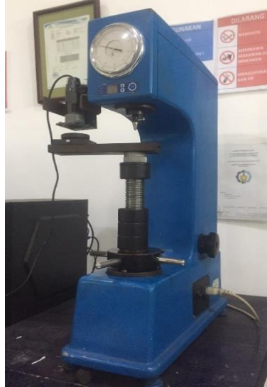
Gambar 3.3 Universal Hardness Tester HBRV (Dokumentasi Pribadi, 2022)
