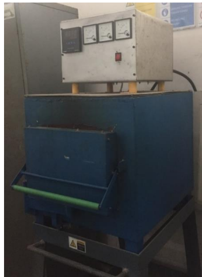
Gambar 3.2 High temperature furnace (Dokumentasi Pribadi, 2022)
