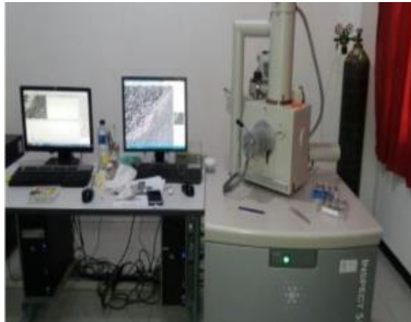
Gambar 3.8 Mesin uji SEM merk HITACHI SU3500
