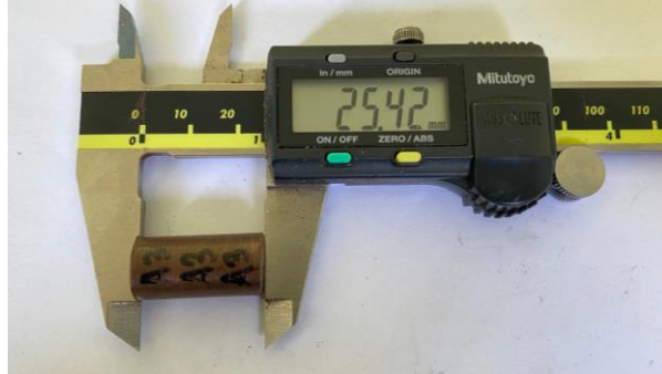
Gambar 3.10 Spesimen uji tekan dengan diameter 12,7 mm dan tinggi 25,42 mm
