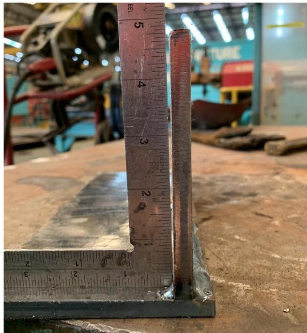
**Gambar B.2** Hasil deformasi pada pengelasan eksperimen
