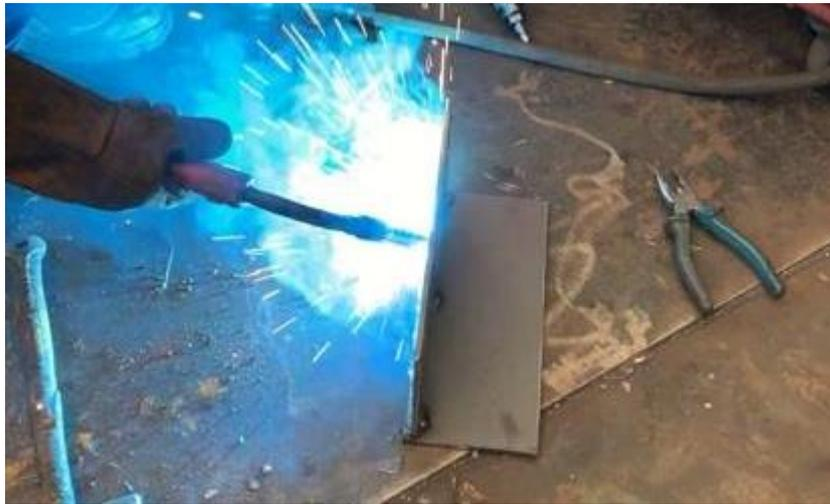
**Gambar B.1** Proses pengelasan sambungan T
