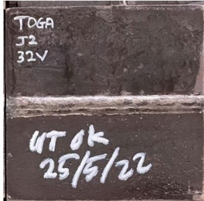
**Gambar 4. 3** Material S355J2 32 V setelah dilakukan pengujian NDT *ultrasonic*
