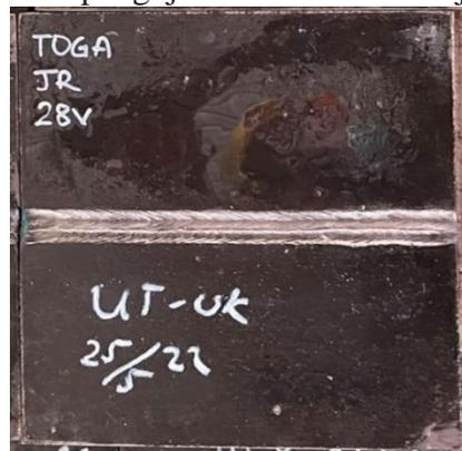
**Gambar 4. 4** Material S355JR 28 V setelah dilakukan pengujian NDT *ultrasonic*
