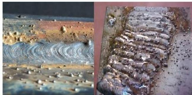
**Gambar 2.9** Skema cacat las *Over Spatter*
