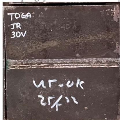
**Gambar 4. 5** Material S355JR 30 V setelah dilakukan pengujian NDT *ultrasonic*
