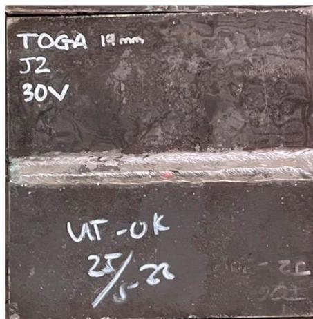
**Gambar 4. 2** Material S355J2 28 V setelah dilakukan pengujian NDT *ultrasonic*
