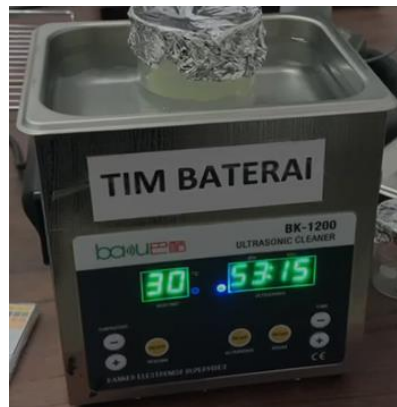
Gambar 3. 34 Sonikasi sulfur dengan deionisasi water
