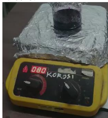
Gambar 3. 35 Proses magnetic stirrer sulfur dan KMnO_4
