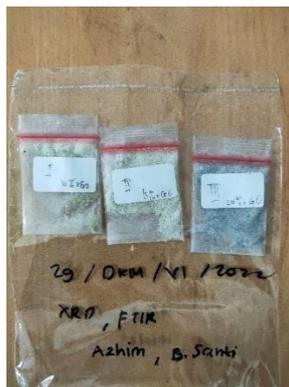
**Gambar 4. 2** Hasil Sintesis Komposit ZnO/rGO dengan Variasi Massa 10% rGO, Massa 15% rGO, dan 20% rGO
