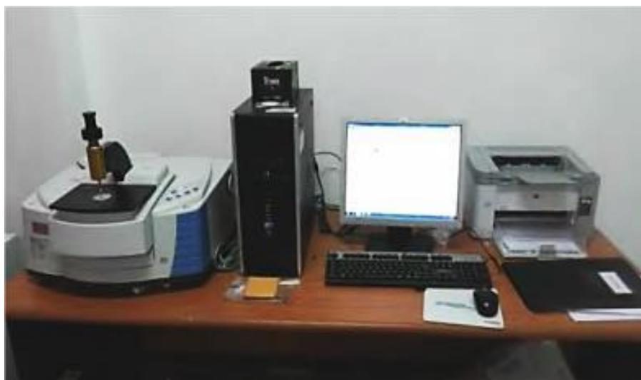
**Gambar 3.7** Alat uji FTIR
