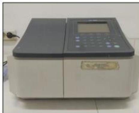
Gambar 3.9 Alat Uji UV-Vis
