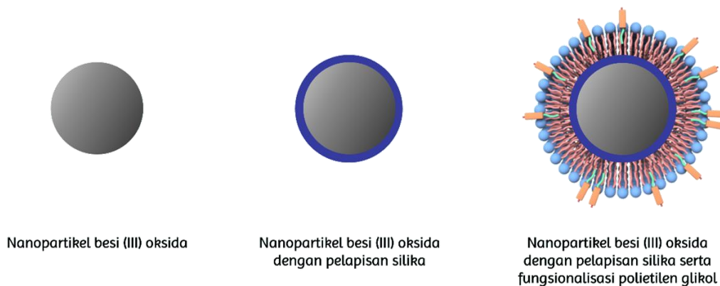
Gambar 3.11 Skema pembuatan nanopartikel magnetik bersalut silika dengan fungsionalisasi polietilen glikol
