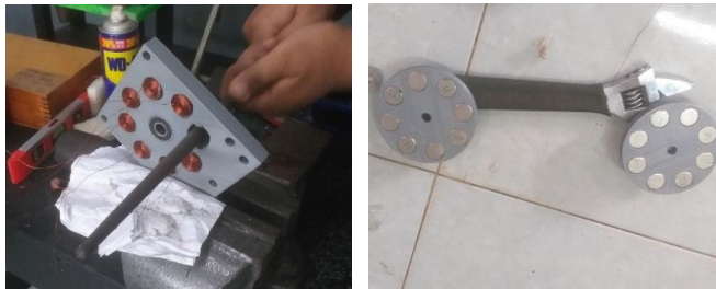
Gambar 50. Proses pembuatan coil dan pemasangan magnet
