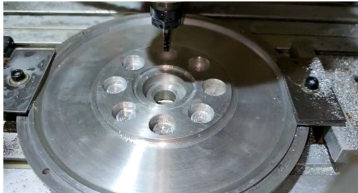
Gambar 61. Pembuatan Cover WHM dengan Magnet AFPMSG
