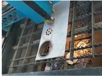
Gambar 57. Pembuatan Stator menggunakan Laser Fiber
