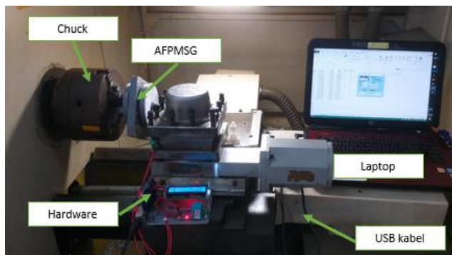
Gambar 45. Pengambilan data AFPMSG dengan CNC Lathe
