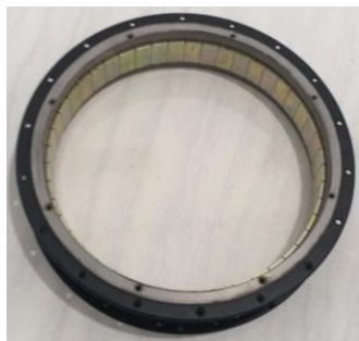
Gambar 8. Rotor Wheel Hub Motor dengan system ruji
