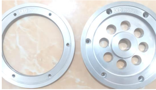
Gambar 59. Bagian stator untuk cover AFPMSG gulungan tembaga
