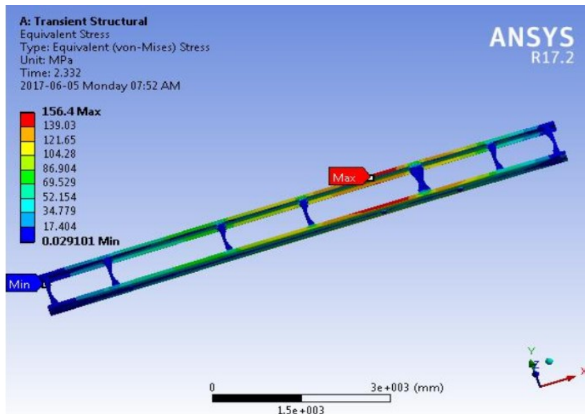
Gambar 2.35 Tegangan sasis pada analisa dinamis
