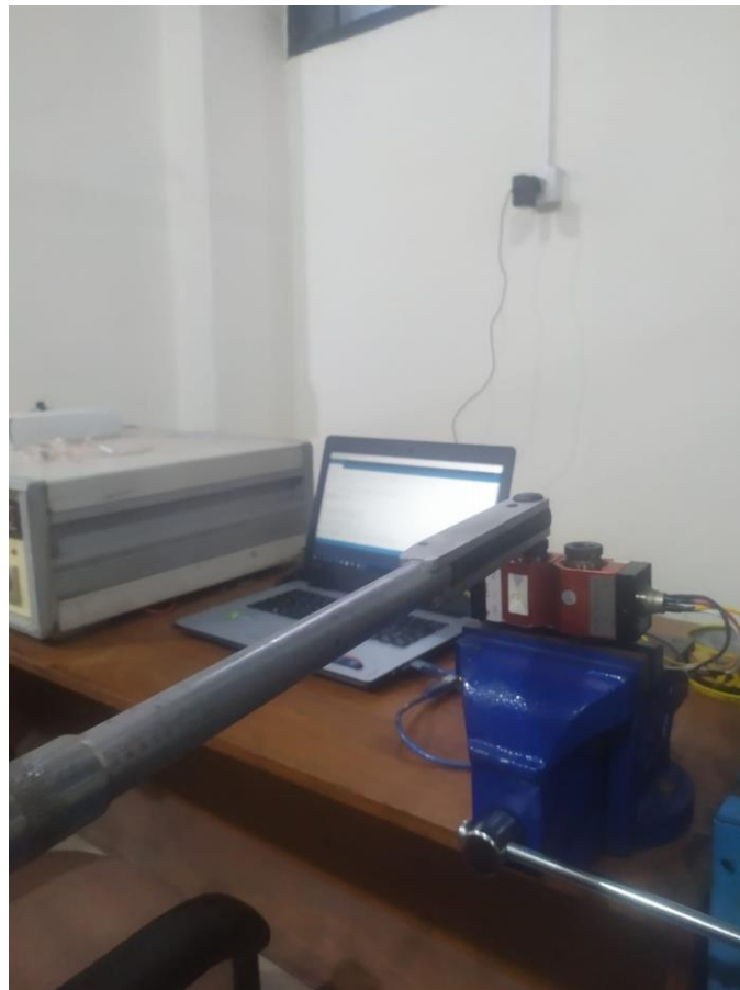
Instalasi kalibrasi torque meter
