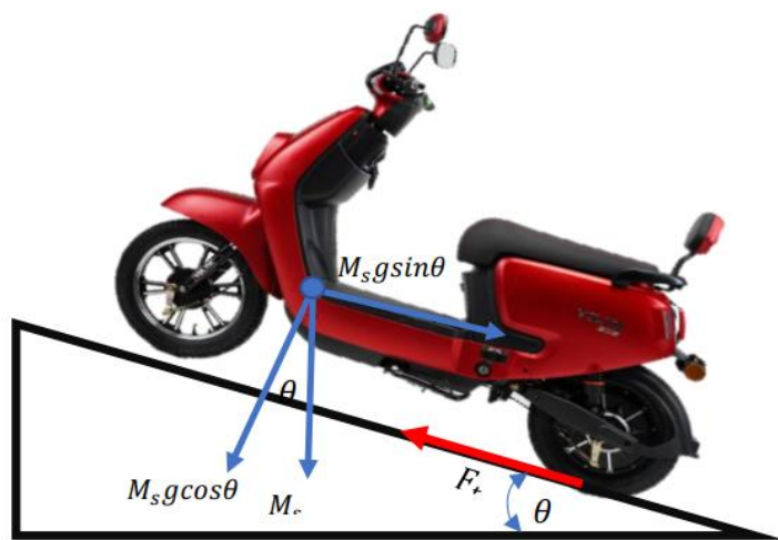
Gambar 2.3 Gaya – Gaya yang bekerja pada skuter saat menanjak pada slope \theta
