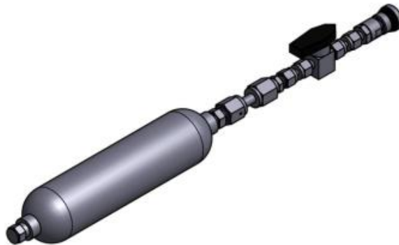
Gambar 2.10 Geometri untuk pengujian dengan volume 285 cm 3 yang dapat menampung 961 gram metal hydride [7]
