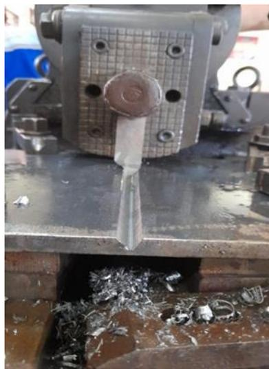
**Gambar 3. 4. Proses pembuatan kampuh V**
