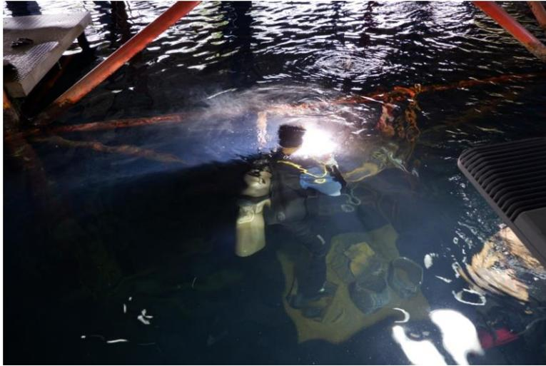
**Gambar 3. 6. Proses Pengelasan Bawah Air yang dilakukan di Solo Techno Park**
