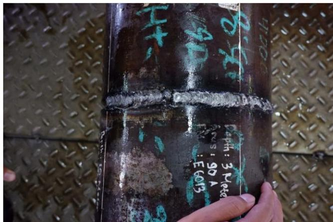
**Gambar 3. 7. Hasil pengelasan dalam air pada material pipa A106 yang dilakukan di Solo Techno Park dilakukan pengamatan secara visual**
