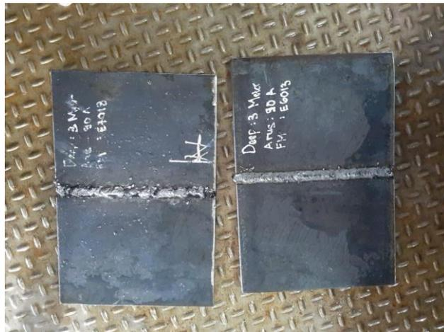
**Gambar 3. 8. Hasil pengelasan dalam air pada material Plat A36 yang dilakukan di Solo Techno Park dilakukan pengamatan secara visual**
