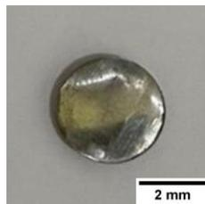
Gambar 3. 11. Contoh spesimen uji korosi yang sudah dipotong
