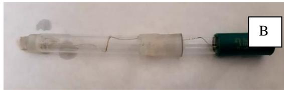
**Gambar 3. 13.** (A) elektroda acuan / refrence electrode (Ag/AgCl), (B) elektroda pembantu / counter electrode (Pt)
