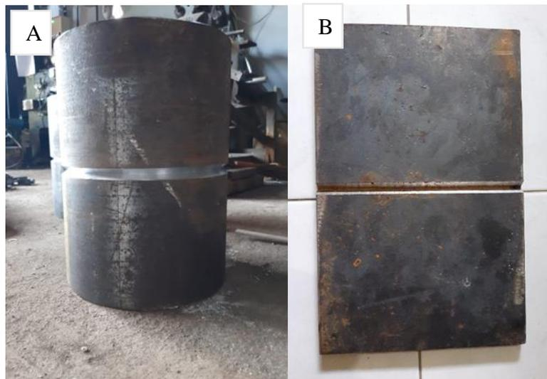
**Gambar 3. 5. Hasil pembuatan kampuh V pada (A) pipa A106 dan (B) Plat A36**
