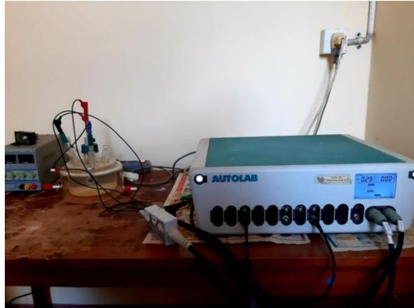
**Gambar 3. 15.** Alat potensiostat yang digunakan dalam uji korosi
