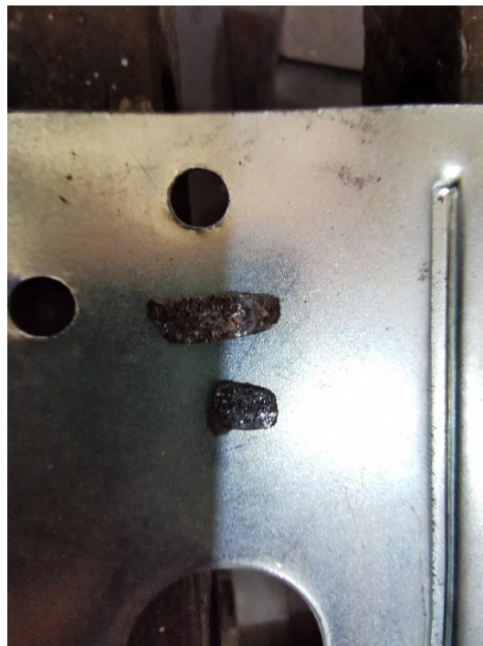
Gambar 4.11. Bagian fin dari tube yang terbakar
