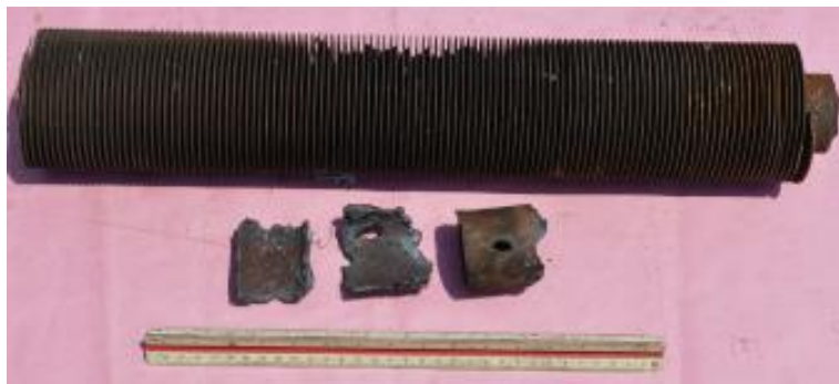
Gambar 2. 1. Sampel evaporator tube unit HRSG yang gagal (Gupta dkk, 2019)
