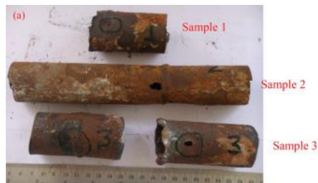
Gambar 2. 7. Sample tube yang mengalami kegagalan (Pal dkk, 2019)
