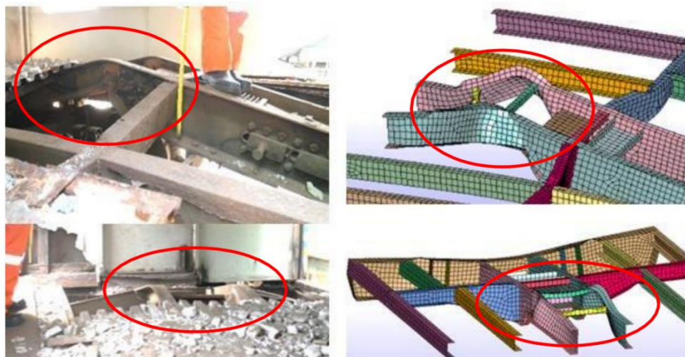
Gambar 2.7 Mode kegagalan yang terjadi pada Centersill (Setiawan et al., 2019)
