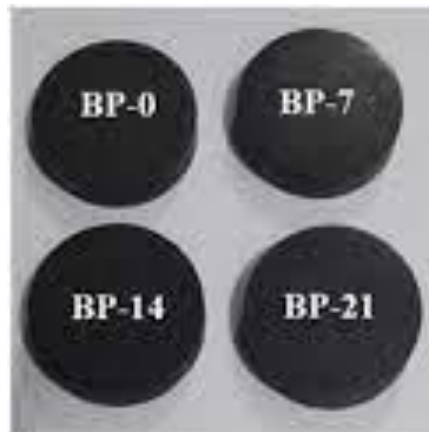
Gambar 2.3 Spesimen Uji Kampas Rem yang Terbuat dari Ligno-Selulosa
