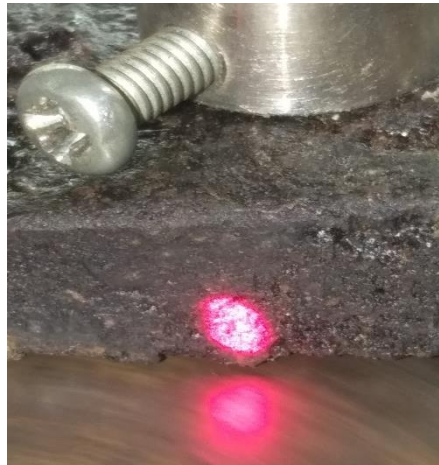
Gambar 3.13 Pengukuran Temperatur Spesimen Uji Laju Keausan
