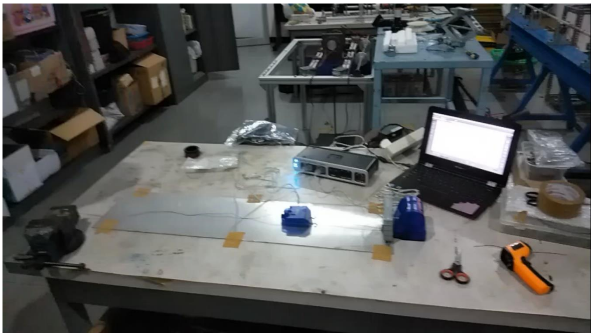
Gambar 3.9 Instalasi Alat Uji Koefisien Gesek
