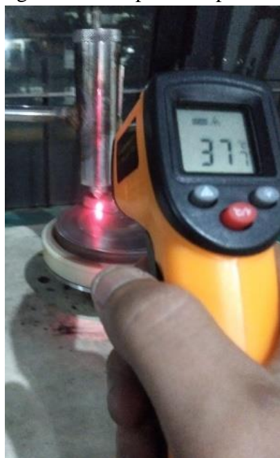
Gambar 3.14 Pengukuran Temperatur Menggunakan Infrared Thermometer
