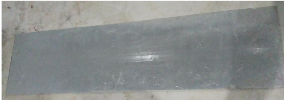
Gambar 3.8 Lintasan Gesek Pengujian Koefisien Gesek
