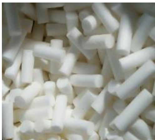
Gambar 2.20 Selulosa Asetat dari Busa Filter Rokok
