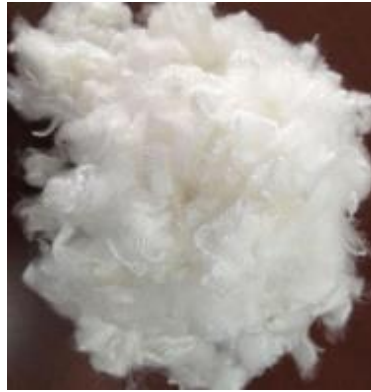
Gambar 3.2 Serabut Selulosa Asetat dari Busa Filter Rokok
