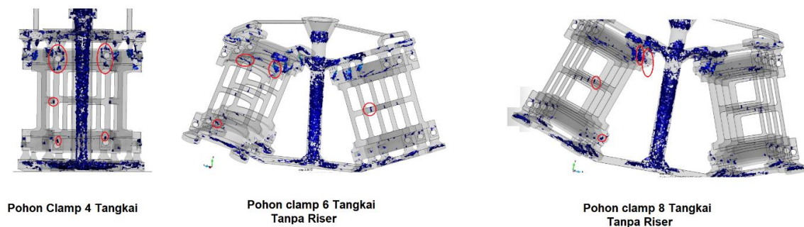
Gambar 4. 15 Cold Shut pada Pohon Clamp Tanpa Riser
