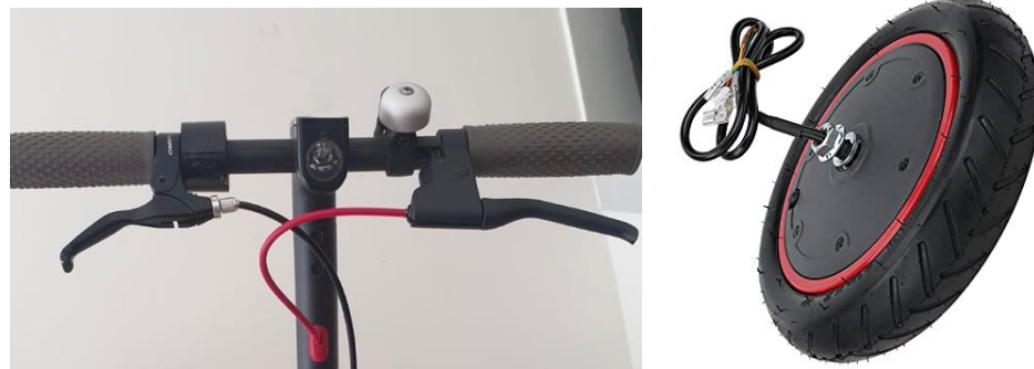
Gambar 3. 3 Tuas Pengereman pada Skuter dan Motor 700 Watt (Rito EasySport)
