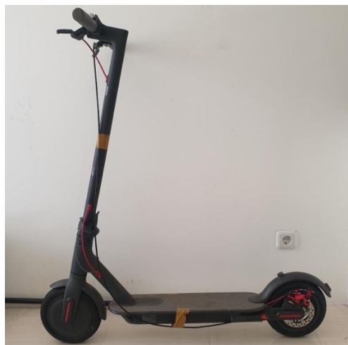
Gambar 3. 4 Kondisi Skuter setelah penggantian motor dan piringan cakram
